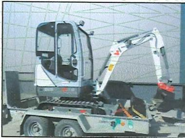
Der Bagger wird mittig der Längsachse in Fahrtrichtung positioniert, sodass die zul. Stützlast nicht überschritten wird. Der Baggerarm mit Schaufel wird formschlüssig auf den Schaufelhalter und von vorn angepresst und hydraulisch blockiert. Das Gummikettenfahrwerk wird hydraulisch und der Oberwagen mechanisch blockiert. Das Bagger muss so positioniert werden, dass das Stützschild in Fahrtrichtung nach vorn zeigt.
